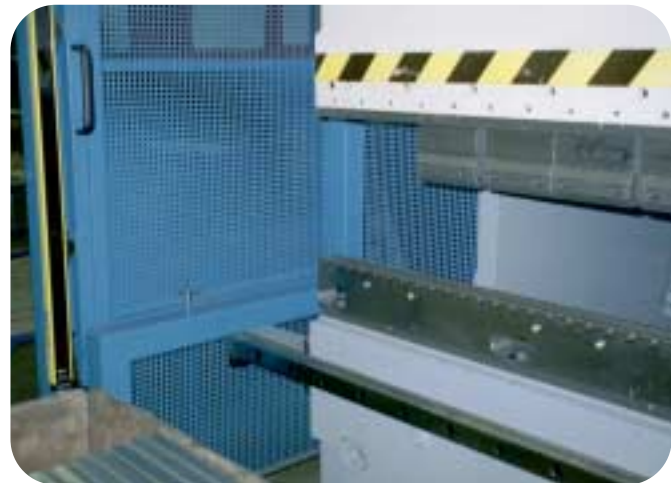
Figure 17 : Exemple de protecteur latéral.
