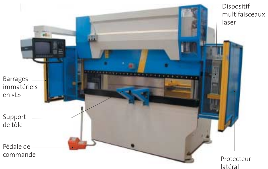
Figure 1 : Presse plieuse hydraulique présentant divers dispositifs de protection.
