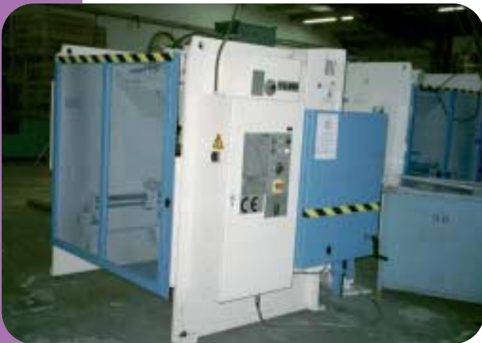
Figure 16 : Exemple de protection de la face arrière.
