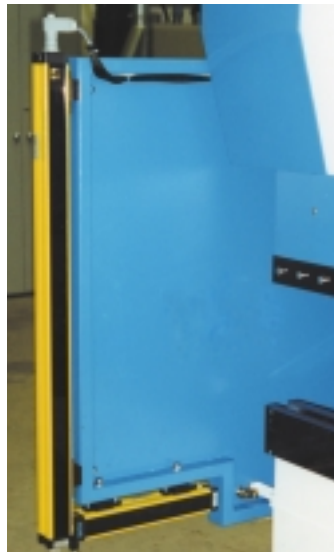
Protecteur latéral supportant une barrière immatérielle (photo INRS)
