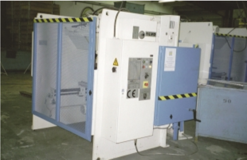
Protection de la face arrière (photo Jean-Pierre Caillet)
