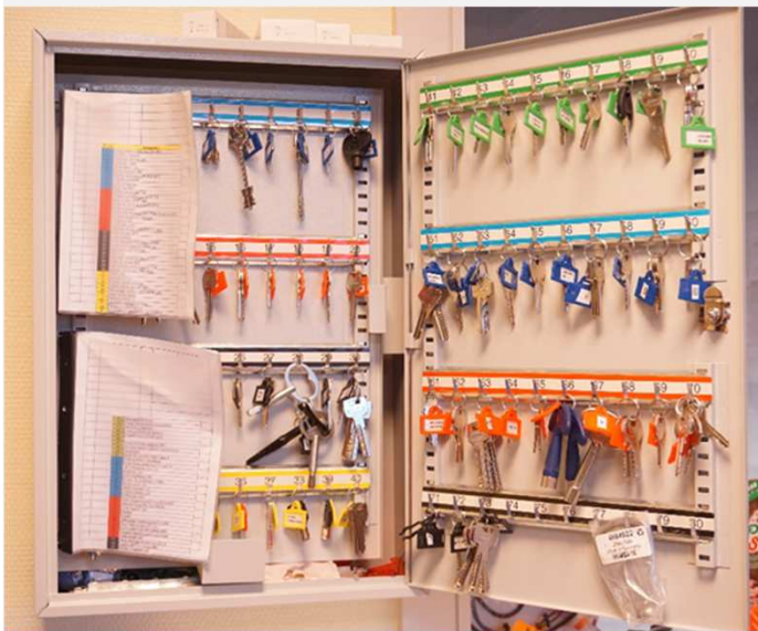
Boites à clés avec code couleur (locaux techniques / machines / clés de consignation)
